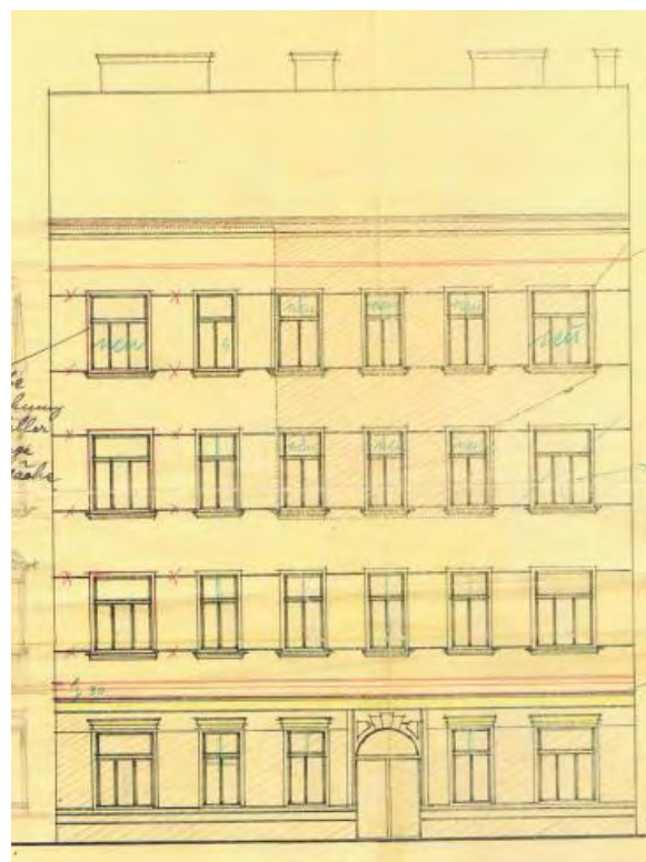
Abbildung 14: Wiederaufbauplan 1948 - Bestandsansicht Straßenfassade Eberlgasse [Quelle: Andreas Kronberger]
